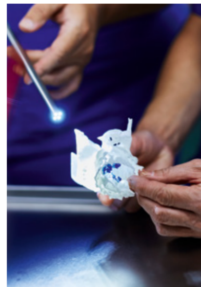
Freie Sicht: Videoendoskop mit 10 mm Durchmesser.
